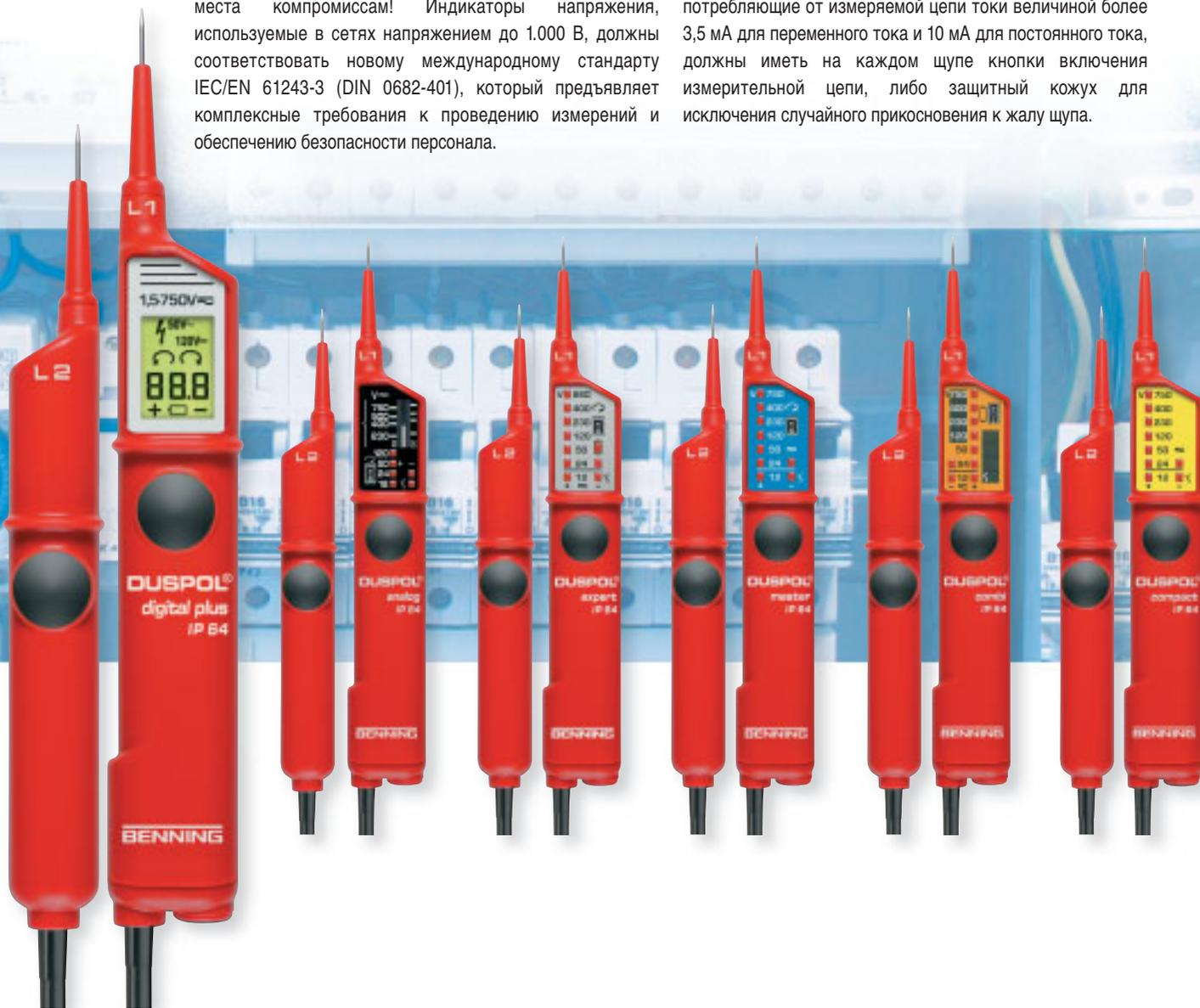
Все индикаторы напряжения новой серии **DUSPOL®** подключаются к месту измерения посредством нажатия на каждом пробнике кнопок подключения измерительной цепи. Таким образом, удается избежать воздействия паразитных наведенных индуктивного и емкостного напряжений.
